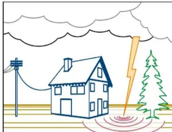
Κεραυνικό πλήγμα κοντά σε κτίριο
